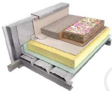
Répandu sur un système de drainage constitué de plaques Sarnadrain-20+ ou un feutre Aquadrain-550, le substrat Sarnavert est ensuite ensémené d'un mélange de graminées, d'herbacées et de sedums. Il faut compter environ 12 mois pour une couverture satisfaisante de la toiture par la végétation. Sarnavert convient à tous types de climat et se présente comme la solution la plus économique.
