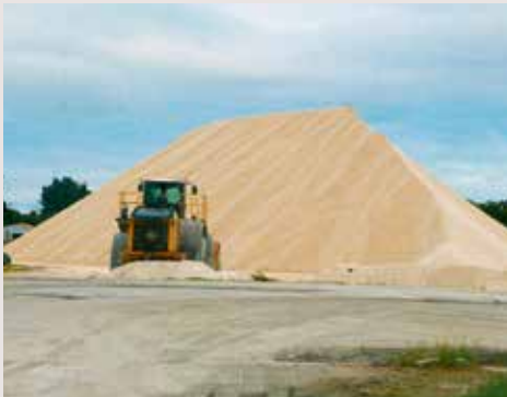
Figure C : les stocks exploités non colonisés sont talutés à 45° afin d'éviter toute nouvelle colonisation (des rubans effaroucheurs peuvent également être installés à proximité).
