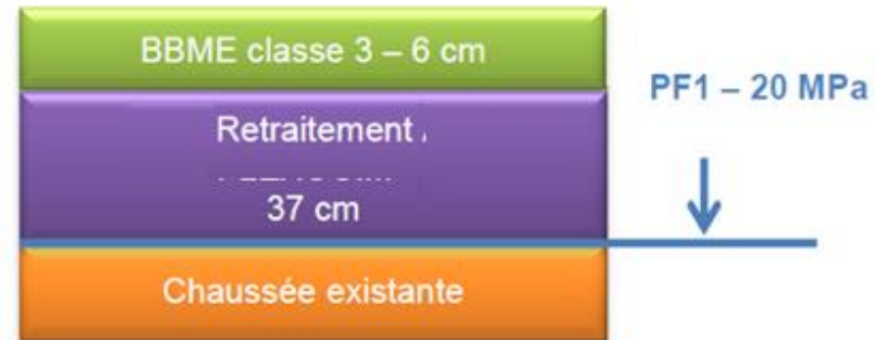
Structure RD 748 La Chapelle St Laurent
