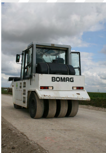
▲ Compacteur à pneus en action.
