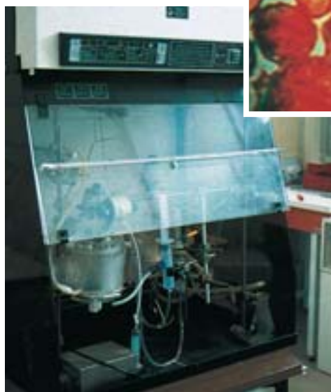
Préparation automatique des échantillons de cru sous forme de perles pour analyse par fluorescence X.
