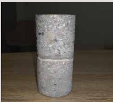
→ Éprouvette de béton intégrant la membrane SEPC.
