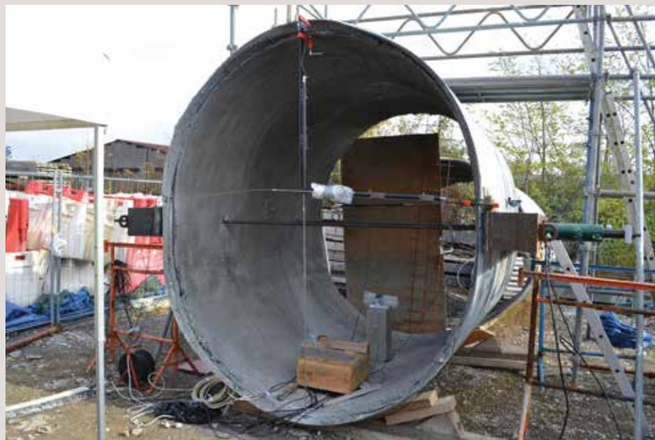
→ Chargement transversal d'une buse témoin renforcée par projection de BFUP.
