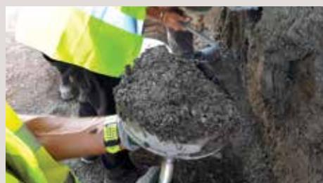
→ Prélèvement de béton projeté fibré pour l'évaluation de la teneur en fibres sur le support.
