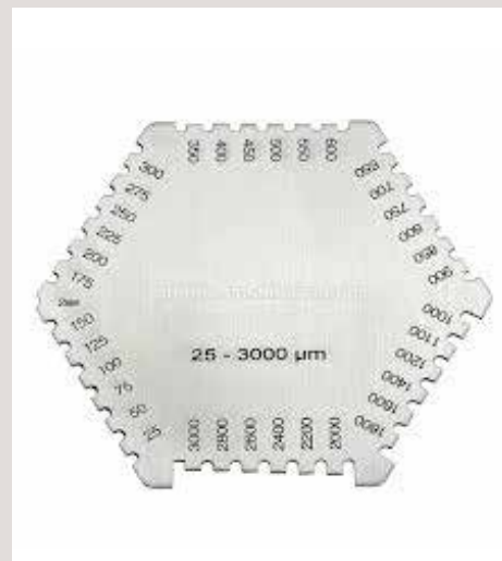
→ Peigne pour mesure de l'épaisseur humide.
