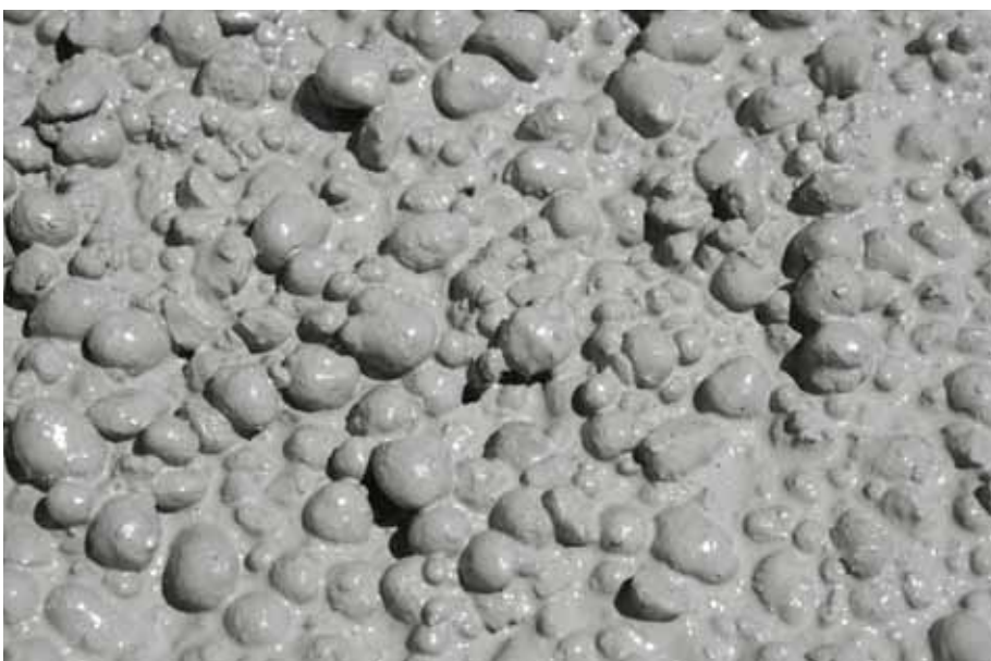
Les bétons «thermiquement efficaces» sont réalisés à partir de formulations très élaborées utilisant des granulats à forte résistance thermique.
