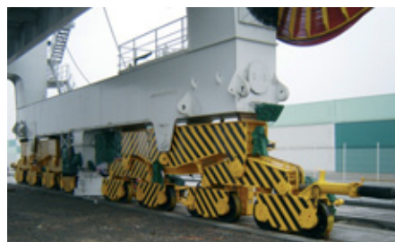
Le portique ferroviaire de 680 tonnes.
