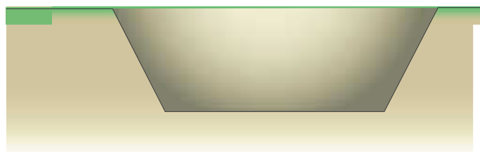
Terrassement de la tranchée en fouille talutée
