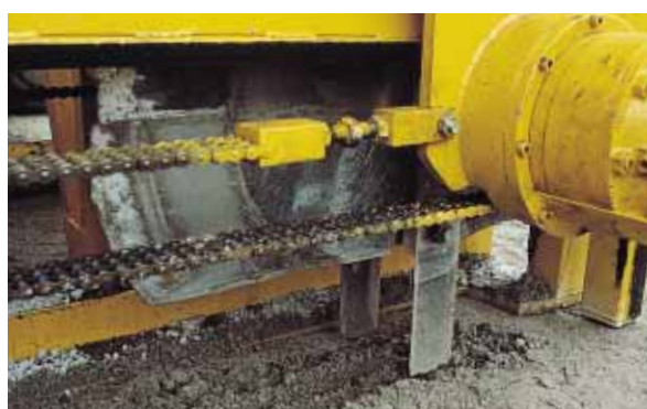
▲ Procédé Setec-Sacer : les deux coupeaux remblaient les matériaux de part et d'autre du joint.
