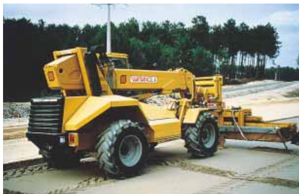
▲ Olivia : la nouvelle machine de préfissuration Viafrance.
