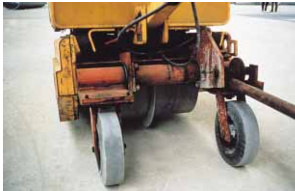
▲ Procédé Viafrance : machine à trancher les joints en position de transfert.
