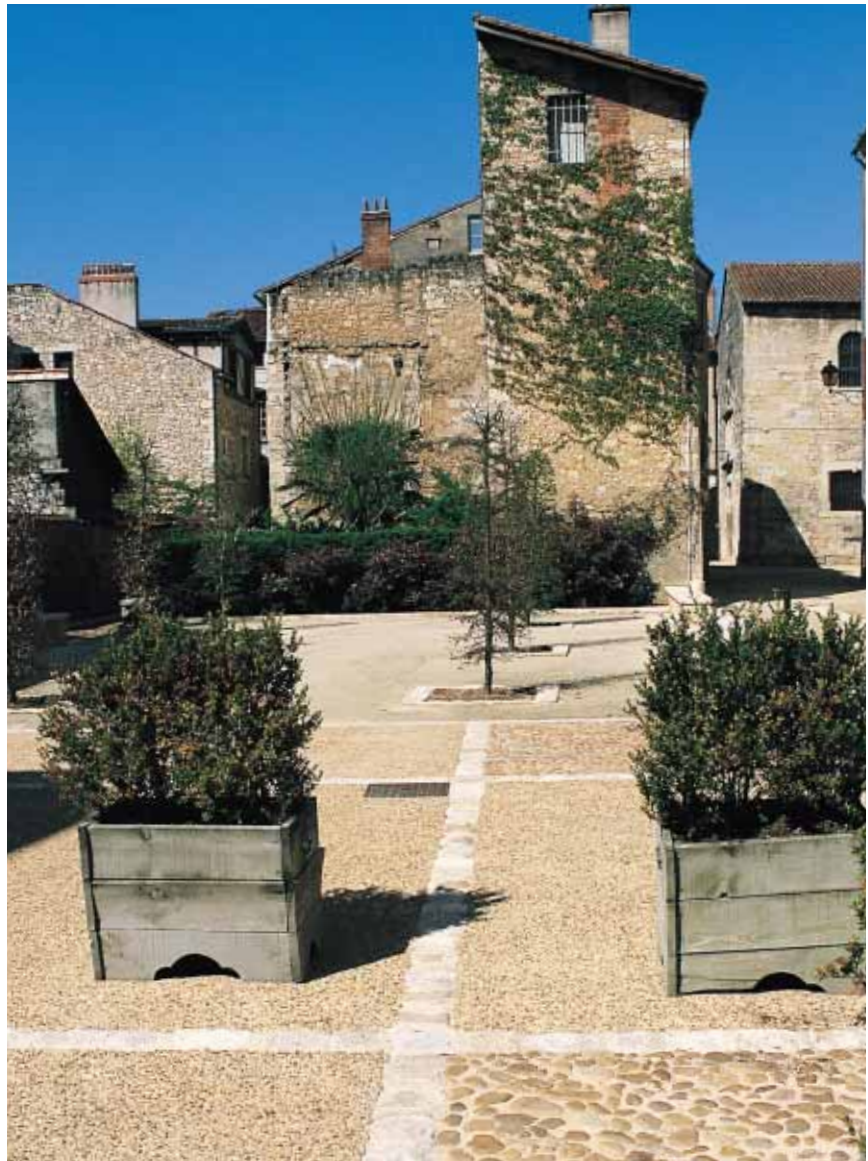
▲ Périgueux : la combinaison de deux granulats de taille très différente et le calepinage de pierres plus important apportent un cachet particulier à cette petite place enchâssée dans le bâti ancien.
