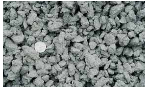
▲ Gage de son efficacité, le béton poreux comprend 20 % de vide.
