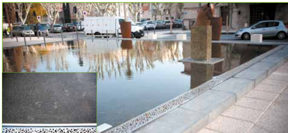
Tain-l'Hermitage : le fond de la seconde fontaine, au pied de la statue du Taurobole, a été réalisé en béton noir poli, avec incrustation de billes de verre.
