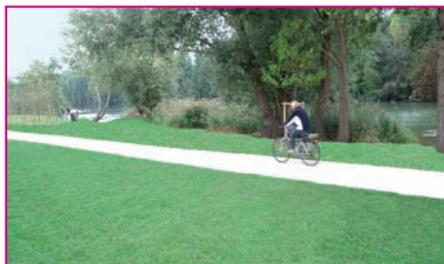
réaménagement en piste cyclable des berges de l'Aisne, la commune de Choisy-au-Bac a voulu que le tronçon traversant l'agglomération soit réalisé en béton stabilisé sans colorant. Eurovia Picardie a mis en œuvre cette piste de 300 m de long sur 3 m de large, légèrement désactivée en surface sur 1 mm d'épaisseur.
