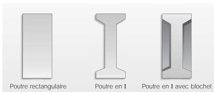
Figure 5: poutre rectangulaire et poutres en I
