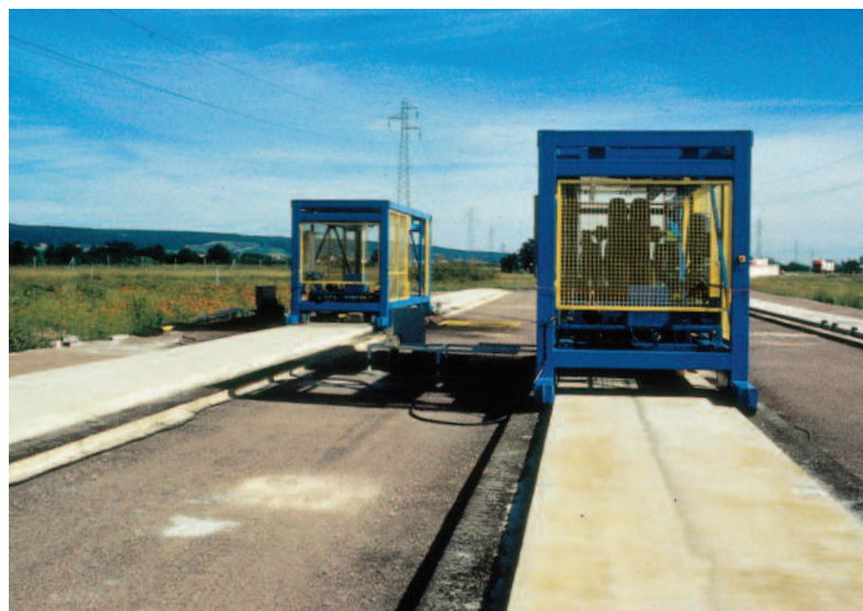
Projet national FABAC : vue d'ensemble du polygone d'essai et des deux machines de fatigue à Gevrey Chambertin.
