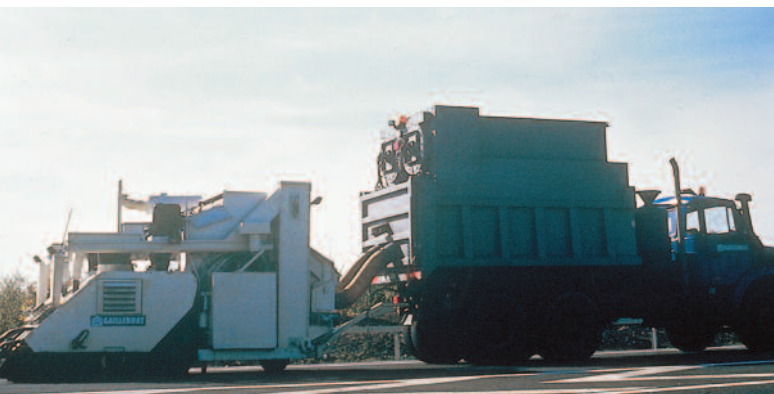
Atelier de grenailage : nettoie et régénère la rugosité d'un revêtement béton.
