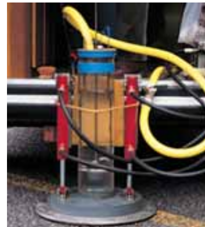
Drainomètre de chantier : mesure de la perméabilité.
