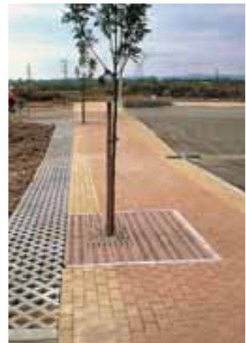
Pavés et dalles gazon à vocations écologique et hydraulique.
