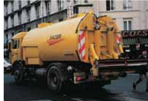
Aspiratrice utilisée pour le nettoyage des surfaces rugueuses.
