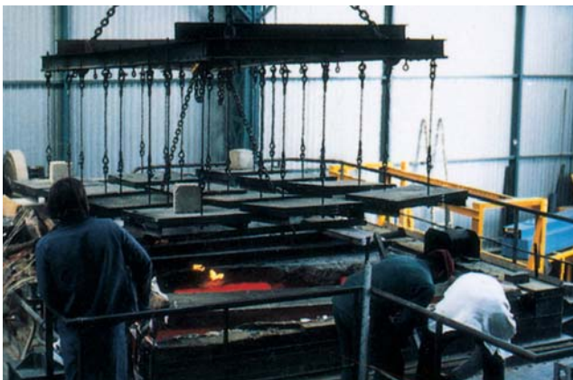
Essai de plancher béton sur four horizontal
