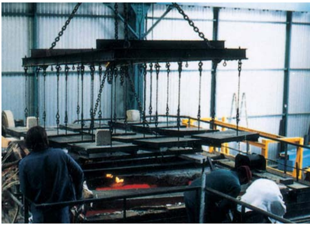
Essais de résistance au feu d'un plancher en béton sur four horizontal, par le laboratoire du Centre scientifique et technique du bâtiment (CSTB).
