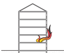
transmission d'un étage à l'autre par la façade à laquelle répond la règle du C + D
