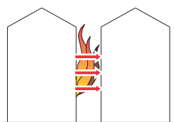
transmission par rayonnement d'un bâtiment à l'autre
