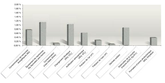
Figure 6. Impacts environnementaux de type FDES normés par rapport aux impacts annuels d'un citoyen Européen pour une poutre en béton armé — échelle linéaire.
