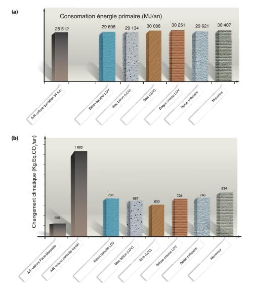
Figure 12. Impacts environnementaux annuels d'une maison individuelle de 100 m² pour une durée de vie de 100 ans et différentes solutions constructives. (a) Consommation d'énergie primaire totale; (b) Changement climatique.
