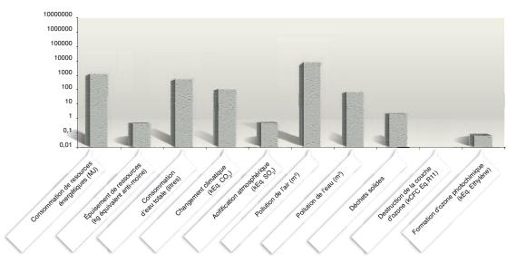
Figure 4. Impacts environnementaux de type FDES pour une poutre en béton armé - échelle logarithmique.
