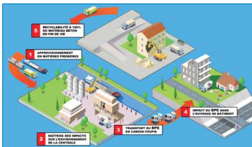
Les cinq phases fondamentales du cycle de vie du Béton Prêt à l'Emploi.
