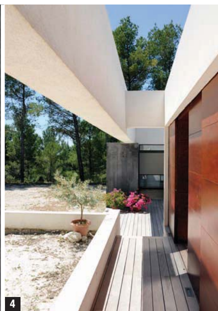
>>>> 1 2 3 et 4 Vues de la terrasse – L'espace extérieur de la terrasse est cadré visuellement et spatialement par des éléments de béton : la poutre blanche s'appuie sur un portique en béton brut teinté.
