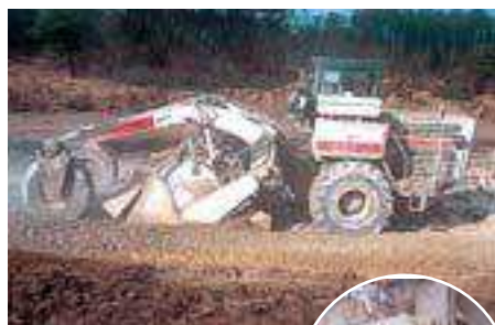
Le malaxeur de 650 CV assure un traitement homogène sur une profondeur de 35 cm.
