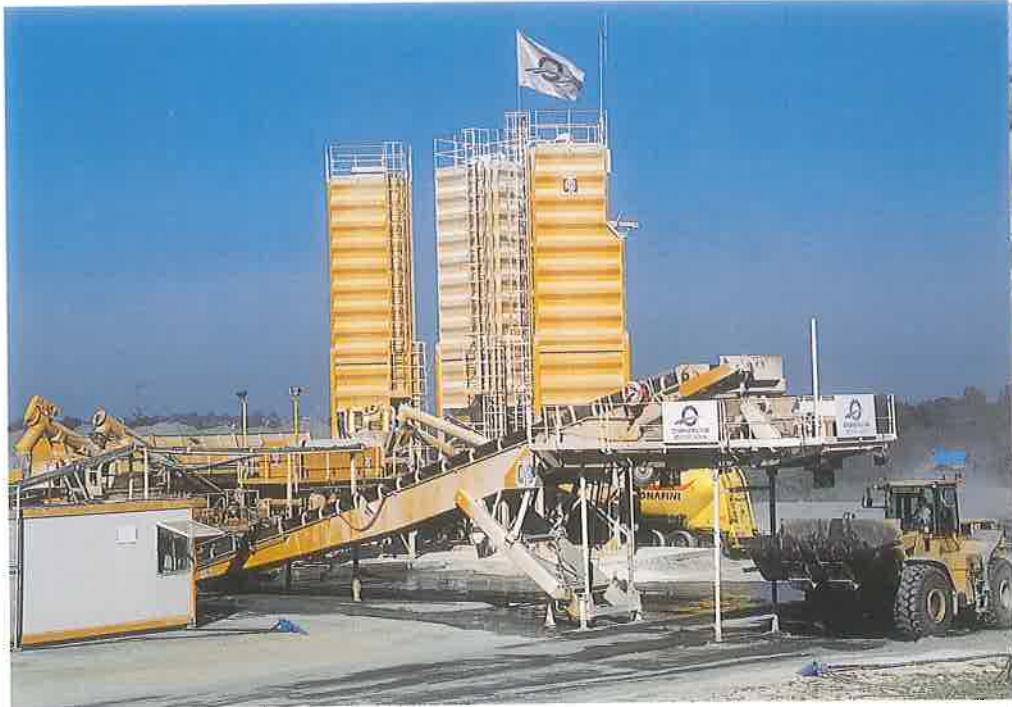
▲ La centrale SAM 804 BI, pilotée par un système informatique Compumat à acquisition de données, est constituée de deux groupes semi-mobiles de dosage pondéral, trois trémies, un doseur à pulvérulents autorégulé, trois silos mobiles, un ensemble de malaxage mixte grave-béton, deux vis de transfert et un poste de chargement en deux points. Elle produit 800 t de sable traité par heure, avec une précision de dosage de l'ordre de 2 %.
