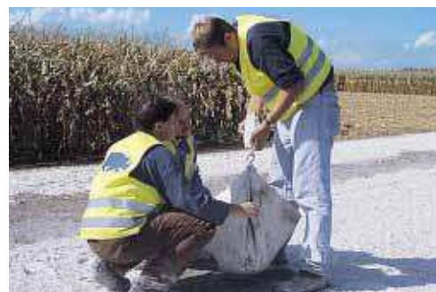
▲ L'essai “à la bêche” permet de s'assurer du respect des quantités de liant répandues (30 kg/m 2 ).
