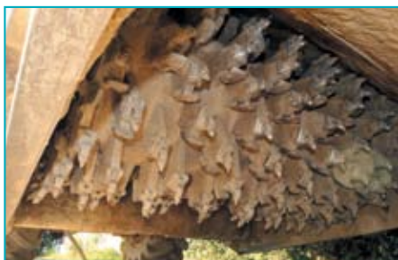
Grâce au rotor de malaxage, les matériaux, le liant et l'eau sont intimement mélangés sur 35 à 40 cm d'épaisseur.
