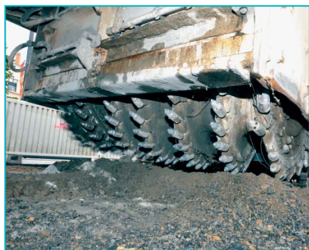
Le rotor permet d'assurer une bonne homogénéité du matériau.
