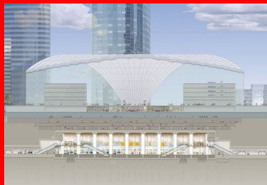
La gare Eole est bâtie sous les bâtiments et parkings abrités par le CNIT.
