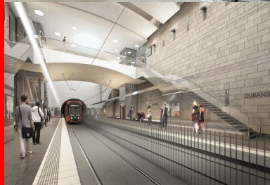
Future station Surandy : les parois moulées seront recouvertes de parements de pierre.
