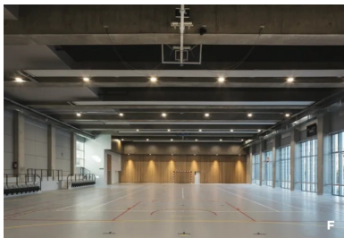
Le gymnase respecte les dimensions réglementaires d'un espace d'évolution de 22x44m et de 7 m de hauteur libre.
