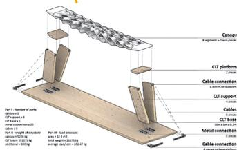
Schéma montage Passerelle Diamanti : impression 3D béton et bois pour une construction bas carbone
