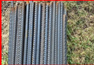
Armatures longitudinales du BAC
