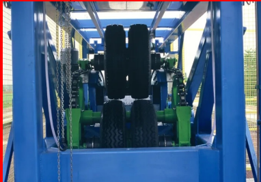
La Machine FABAC : 3 Essieux Standards en rotation qui simule un passage chaque seconde.
