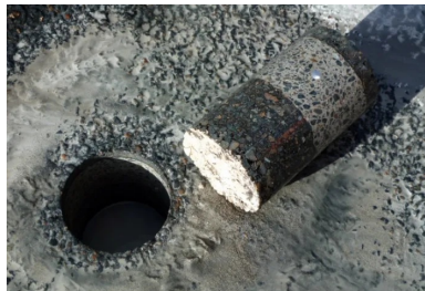
Illustrations du collage entre le béton et la grave-bitume après 15 ans.
