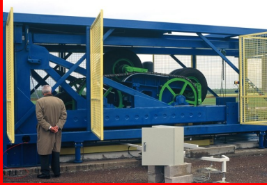
La Machine FABAC peut simuler le trafic en accéléré.
