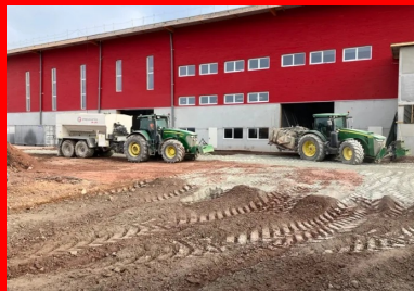
Atelier de traitement. Epandeur tracté Streammaster (à gauche) et Malaxeur tracté Wirtgen WS 250 (à droite). (© Scierie-Gaiffe et Avinim Construction)
