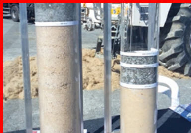
Photo 1 : échantillons avec la différence d'épaisseur de structure entre matériaux granulaires et couche de forme traitée (c) CIMbéton
