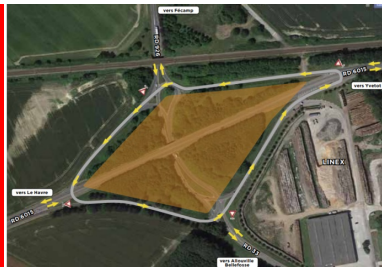
Plan de circulation pendant la phase travaux.
