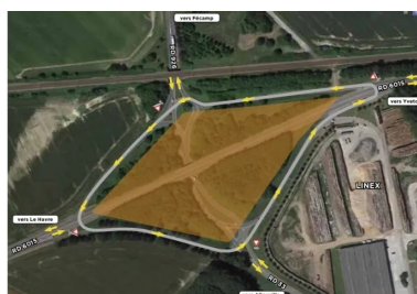
Plan de circulation pendant la phase travaux.
