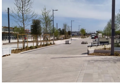
L'aménagement de la grande place Rivierre-Casalis respecte un équilibre minéral-végétal et fait appel à des matériaux clairs pavés et dalles calcaires et béton égrésé.
