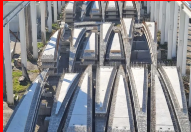
Stockage des « pétales » dans l'usine Capremib, filiale de Demathieu Bard spécialisée dans la préfabrication.
