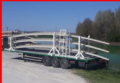
Les racks de transport mis au point par Demathieu Bard permettent de superposer trois pétales.
