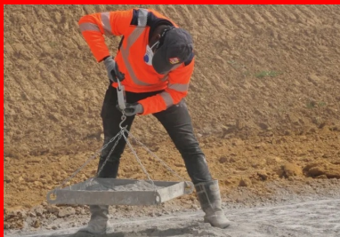
Contrôle de l'épandage par pesée de bâche
