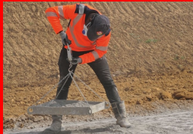
Contrôle de l'épandage par pesée de bâche
