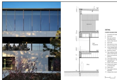
Détail, coupe sur la façade d'entrée.
