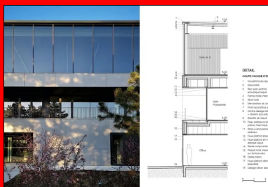
Détail, coupe sur la façade d'entrée.
