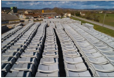
© ACTOPHOTO Stockées à l'extérieur de l'usine, les piles de voussoirs représentent chacune un anneau complet rangé dans l'ordre de pose du tunnelier.
