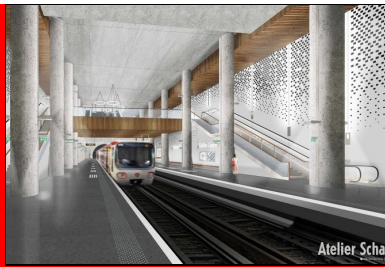
© Atelier Schall Le choix de matérialités - béton brut sur les éléments structuraux, parements ponctuels en bois et Kron 8 perforés sur les murs - vise à donner une dimension humaine aux espaces souterrains.
