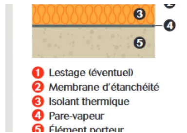
TT - Structure d'une toiture «chaude» Fig.1
