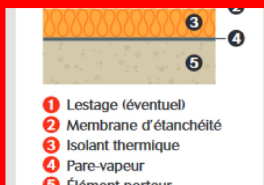
TT - Structure d'une toiture "chaude" Fig.1
