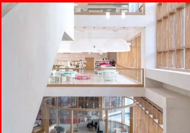
L'intérieur est baigné de la douce lumière du nord. En contrepoint au béton blanc, les ensembles menuisés des châssis sont réalisés en bois. ©L.Ricciotti
