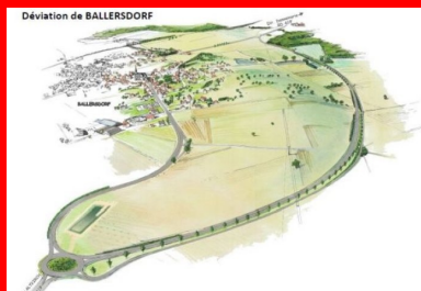
Objectif principal du chantier : détourner la RD419 en réalisant une voie contournant la commune par le nord afin de délester le village d'une bonne partie de son trafic actuel.
