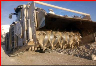
Vue du rotovator du pulvimixeur de l'entreprise Brunner.
