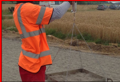
Contrôle de l'épandage au bac
