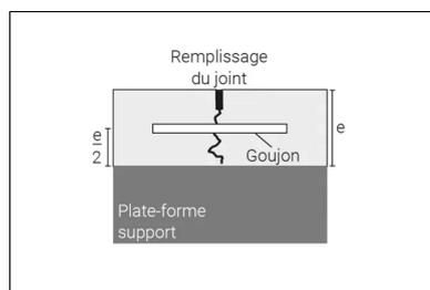
Schéma 2. Schéma d'un joint de construction goujonné.
