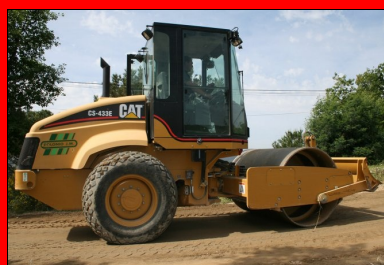
Compactage au rouleau vibrant.
