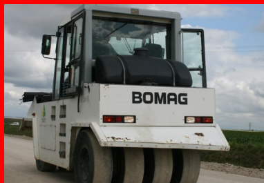
Compacteur à pneus en action.
