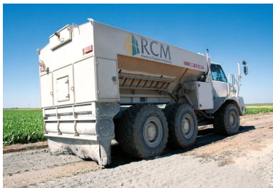
L'épandeur à liant de RCM.
