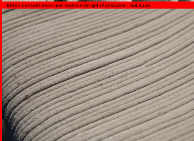
Impression 3D béton par dépôt de couches successives
