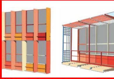
Détails des modules de façade nord et est (à gauche), sud et ouest (à droite).
