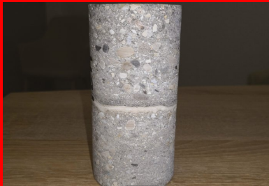
Eprouvette de béton intégrant la membrane SEPC.
