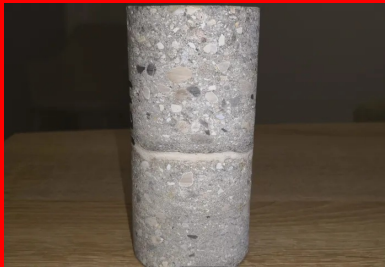
Eprouvette de béton intégrant la membrane SEPC.
