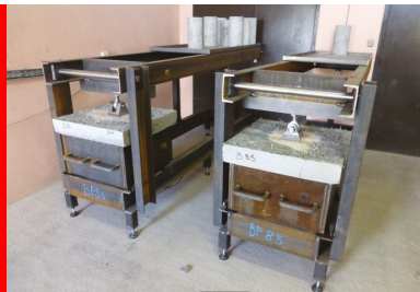
Essai de fluage par poinçonnement-flexion en cours sur les bâtis.
